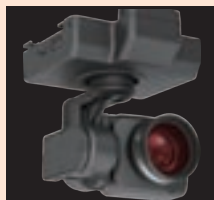
マルチスペクトルカメラ 農業における、NDVI(植生分布指標)値の可視化
