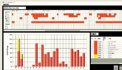
建設機械の稼働状況とCO<sub>2</sub>排出状況を確認するPC画面
