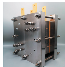
CO 2 から化学品等の原料となるCOを生成するCO 2 電解セル
